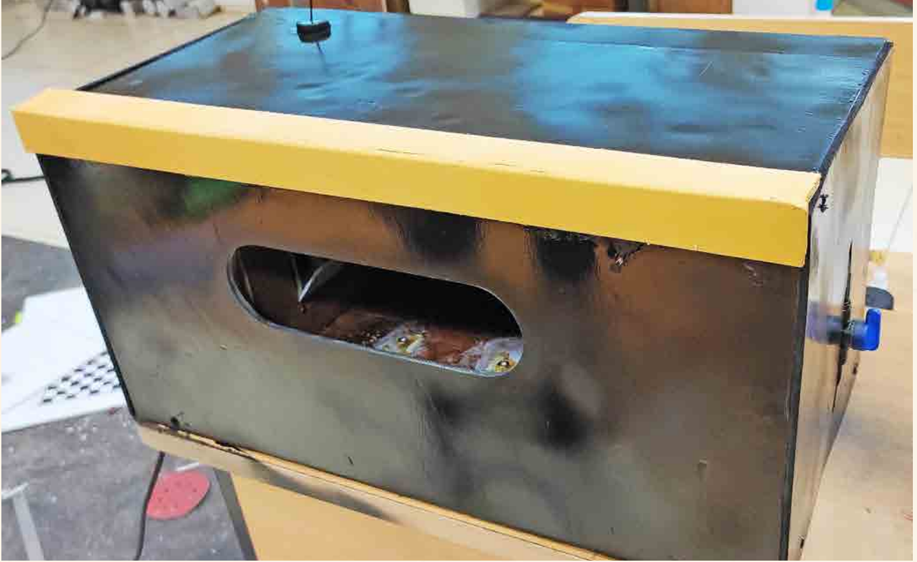
संस्करण 1: औद्योगिक उपयोग के लिए अपने स्वयं के पंप सिस्टम, कंटेनर और धुंध प्रौद्योगिकी के साथ स्वचालित हैंड सैनिटाइज़र।
