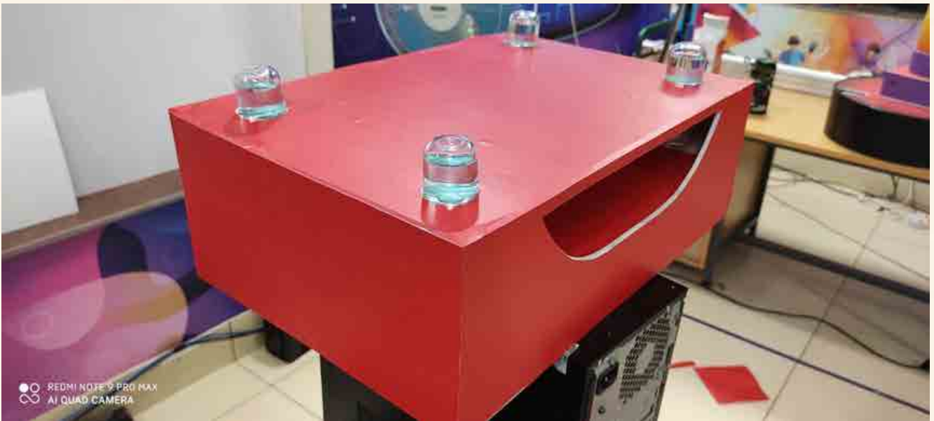
संस्करण 2: अपने स्वयं के पंप सिस्टम, कंटेनर, धुंध प्रौद्योगिकी और व्यक्तिगत उपयोग के साथ-साथ औद्योगिक उपयोग के लिए रिचार्जबल बैटरी पैक के साथ स्वचालित हैंड सैनिटाइज़र
